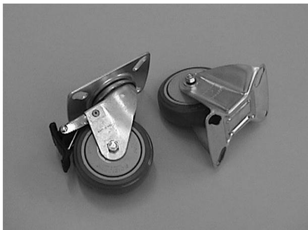
Rodízios com garfo e base em aço zincado e roda injetada em borracha cinza com rolamentos. A roda pode ser fornecida em poliuretano ou nylon, sob consulta.
